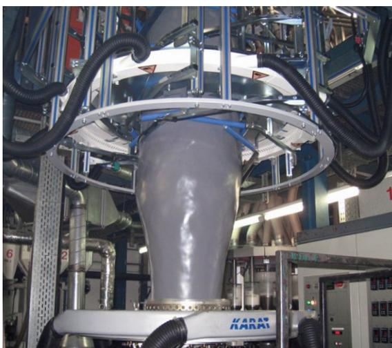
**L'aspirazione è completamente integrata nella calibrazione e** si effettua attraverso elementi girevoli e camere integrate nel perimetro del cestello.
